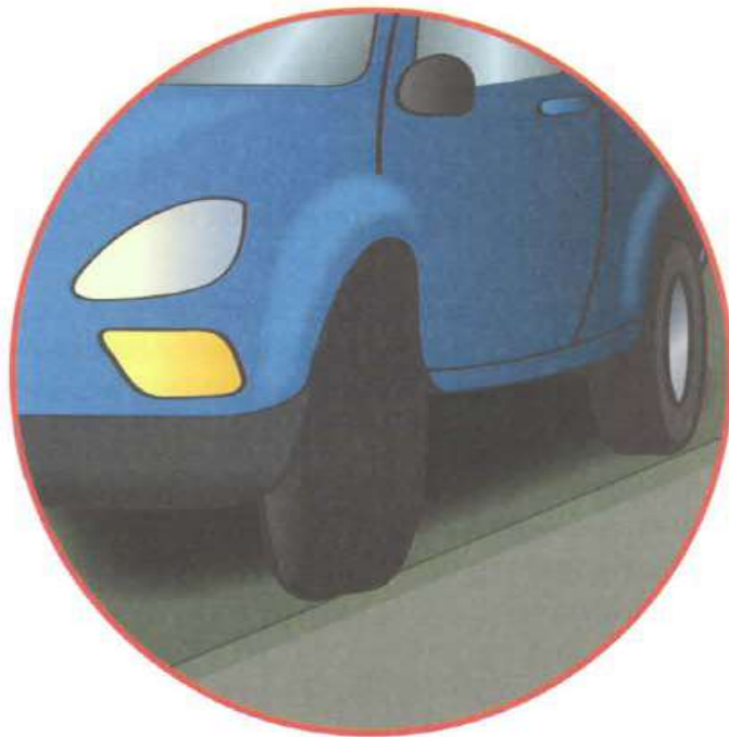
La llanta se debe direccionar hacia el borde de la acera.
